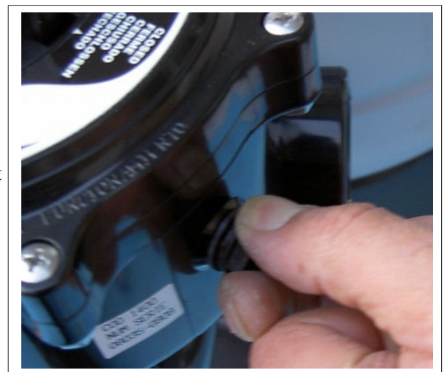
Bild 10 Manometer wird mit Teflonband eingedichtet
