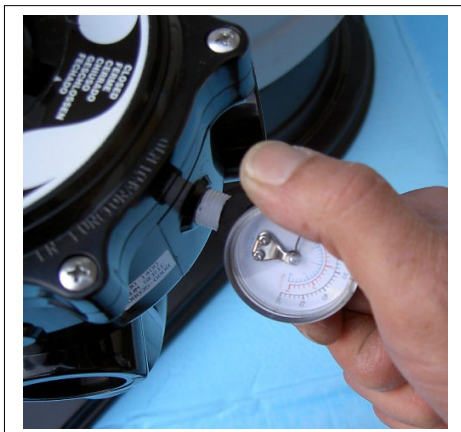
Bild 9 Dichtschaube aus dem 6-Wegeventil wird entfernt
