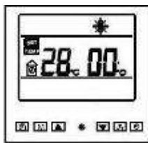
Abbildung 16: Tastensperre, Betriebsweise Heizung.
